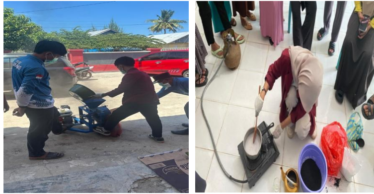
Gambar 5. (a) Penghalusan Arang Batok Kelapa dan (b) Pencampuran Arang Dengan Perekat
