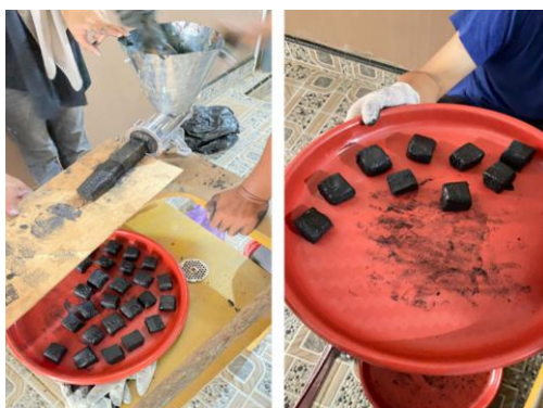
Gambar 6. Proses Pencetakan Briket Menggunakan Mesin Pencetak
