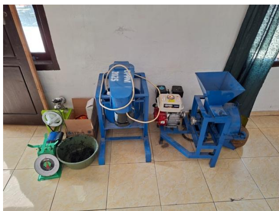
Gambar 7. Teknologi Berupa Mesin Pembuatan Briket dari Arang Batok Kelapa
