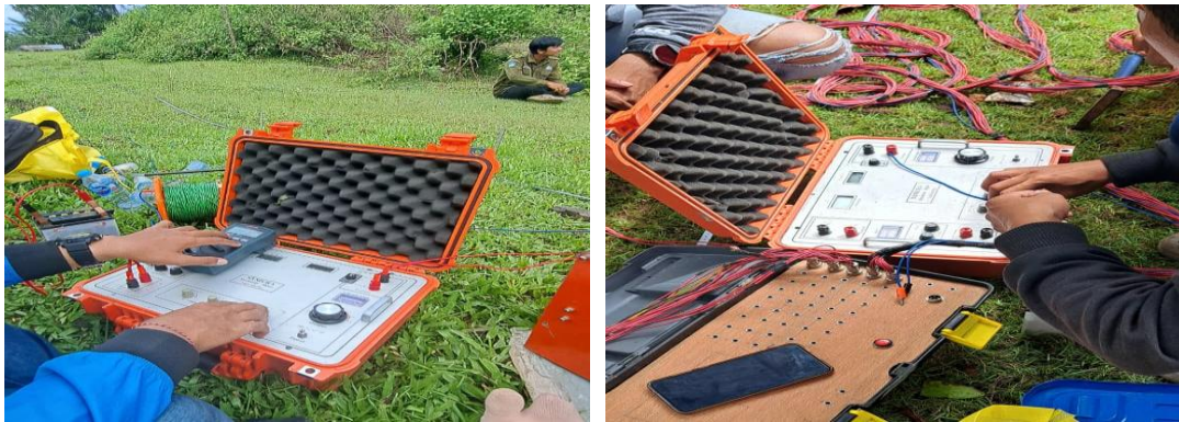
Gambar 8. Proses mengalirkan arus listrik pada sistem geolistrik
