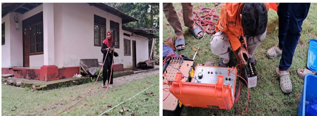
Gambar 7. Proses menghubungkan kabel dengan aki dan elektroda
