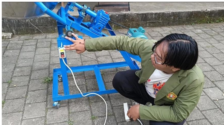
Gambar 4. Proses pengaktifan mesin pengaduk bumbu sebagai tahap awal pencampuran bumbu keripik pisang koin
