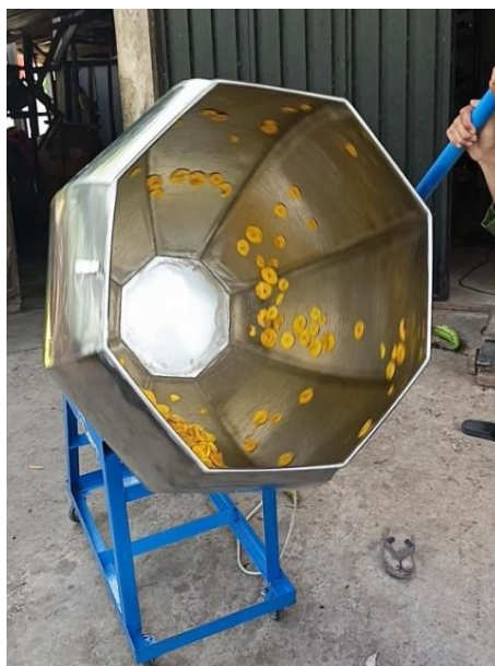
Gambar 5. Proses pencampuran keripik pisang dengan bumbu menggunakan mesin pengaduk bumbu Perbandingan kondisi produksi sebelum dan sesudah penerapan mesin pengaduk bumbu disajikan pada Tabel 1.
