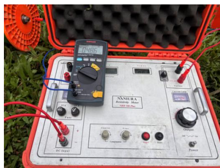
Gambar 3. Alat geolistrik Nainura yang digunakan dalam kegiatan pengambilan data geolistrik.
